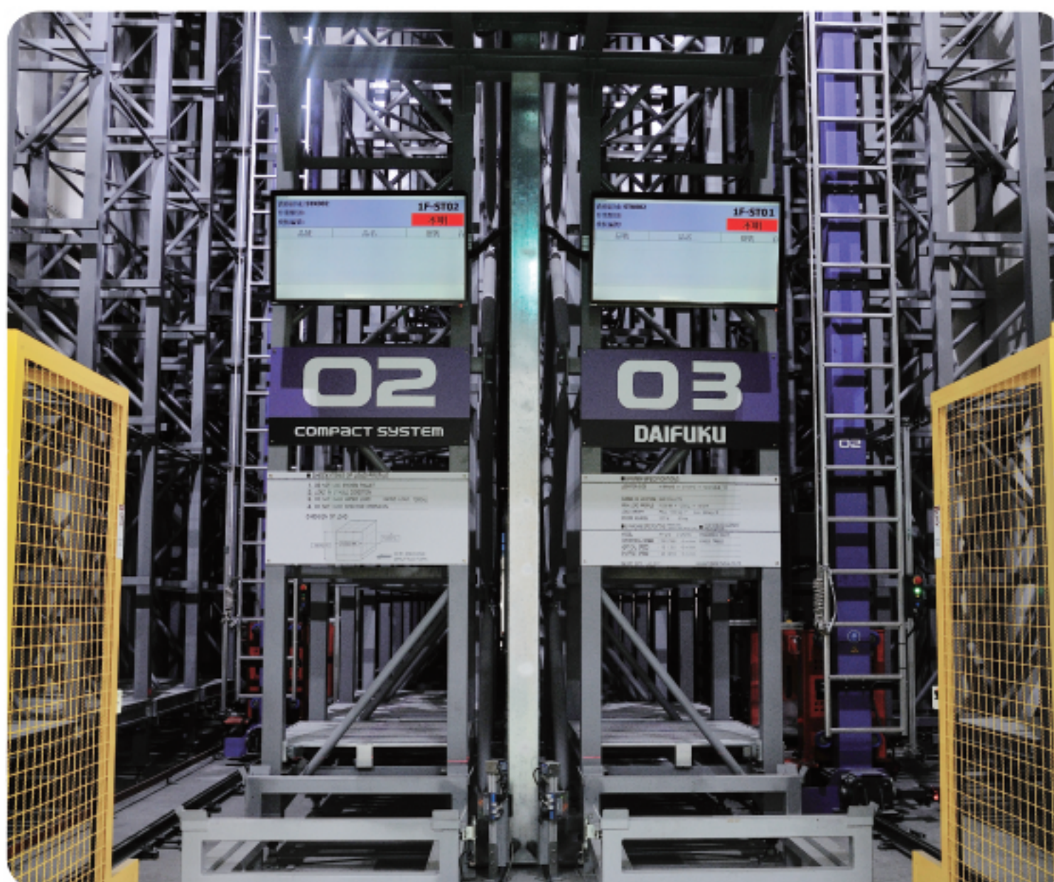
自動倉庫と自動検索システム(AS/RS) ERPシステムと連動して、FIFO基準を従います
